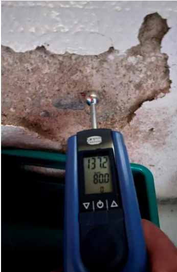
Fugtmåling i væg – 137,2 %
